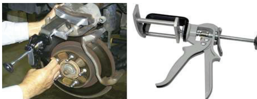
Fig. 1.55. Instalimi i darës së frerit
