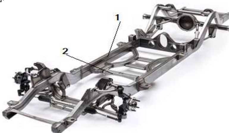
Fig. 4.5. Korniza e profilit gjatësor të një automjeti 1. Bartës gjatësor. 2. Bartës tërthor.
